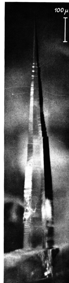
Abb. 10. Whisker mit rasch abnehmendem Querschnitt. 90°-Verzweigung.
